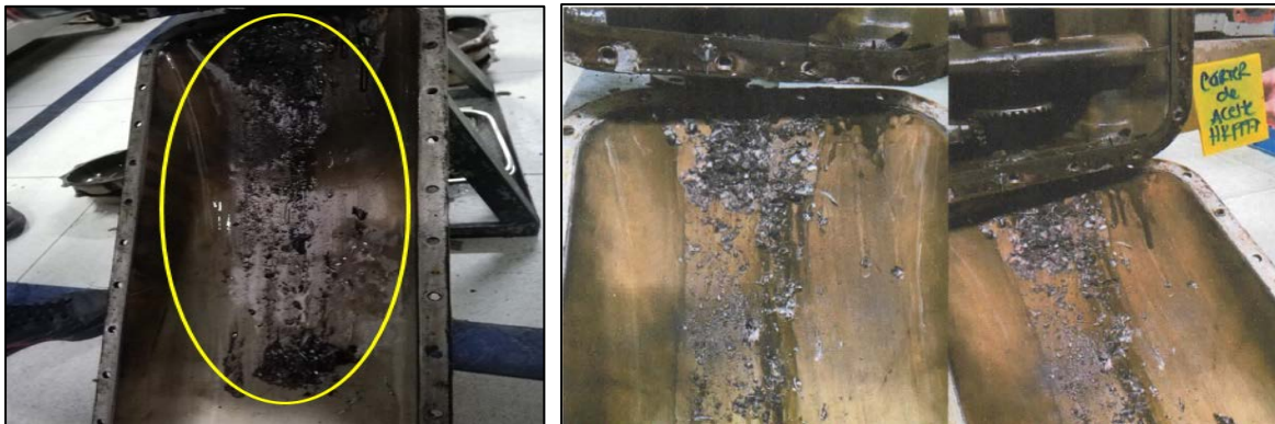
Fotografía No. 5: Evidencia de limalla en el cárter de aceite
