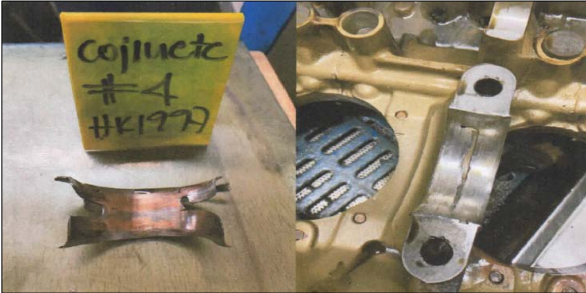
Fotografía No. 6: Cojinete del punto de apoyo #4
